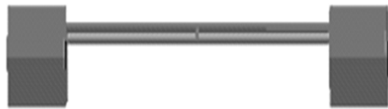
图 1 “H”型谐振梁结构图 Fig. 1 “H” style resonant beam
